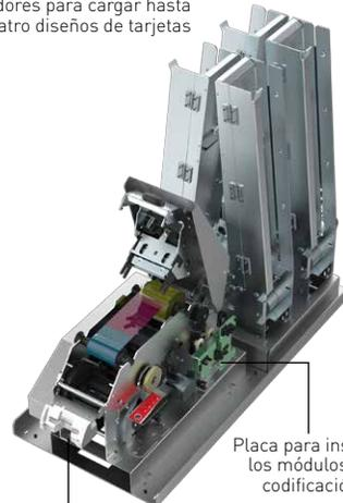
Placa para instalar los módulos de codificación
